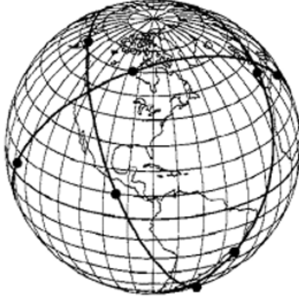
FIGURA 2.5 – Constelação 65:15/3/2 do tipo Walker Delta (WERTZ et al. , 2009).
